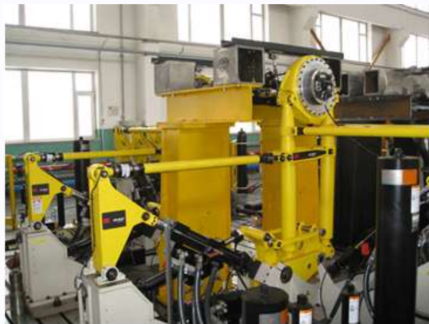
8 通道随机载荷谱台架试验
